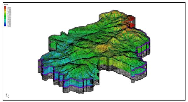
FIGURE 3.1: MODEL DOMAIN FOR TUTUKA POWER STATION
