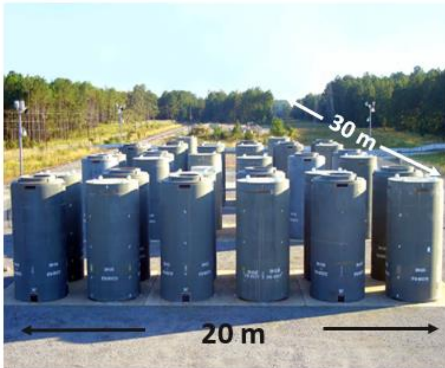
Umfanekiso 17: Umzekelo wefatyi eyomileyo kwindawo yokugcina amafutha enyuk'liya asetyenzisiweyo
